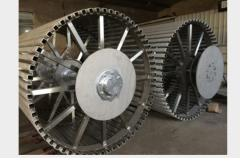
装置内部结构 (除电机外) 全部采用不锈钢和 铝合金材料,卫生条件好,配有优秀的清洗系统, 使装置内无积物污染。
